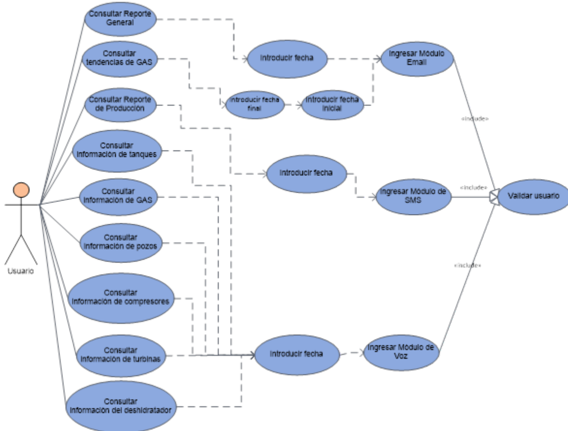
Figura 6 Diagrama de caso de uso general del sistema (IVR)
