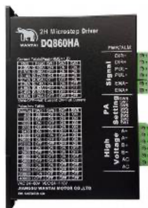
Figura 2. Driver DQ860HA de tipo industrial.
