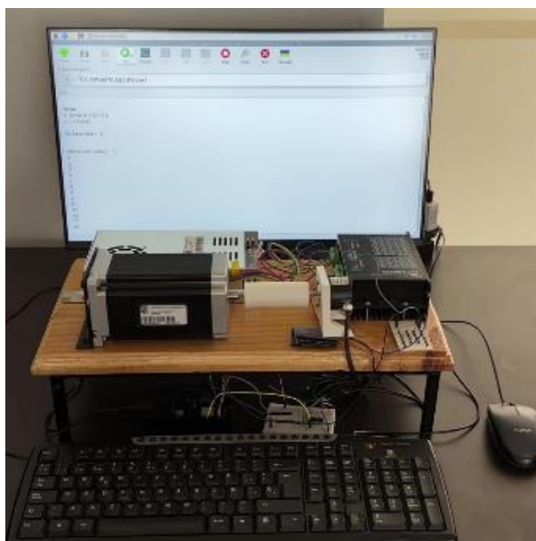
Figura 8. Plataforma experimental de esquema multitareas para control y monitoreo de motor a pasos.
