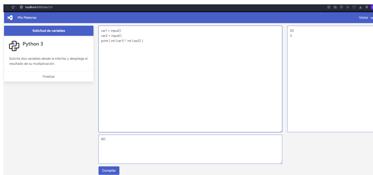
Figura 1. Interfaz del entorno de desarrollo diseñado para la recolección de métricas. La sección izquierda muestra las instrucciones del ejercicio y el botón Iniciar (cambia su etiqueta a Finalizar automáticamente); en la parte central se despliega la caja de escritura de código, la sección de resultados y el botón de compilar; finalmente, la sección derecha presenta una caja de texto para la introducción de variables si es que el ejercicio solicita entradas desde la interfaz.
