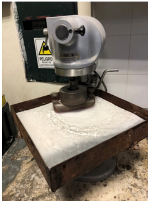
Figura 3. Agitador mecánico modelo Hobart N-50 con bandeja adaptada del LEMaC Elaboración propia
