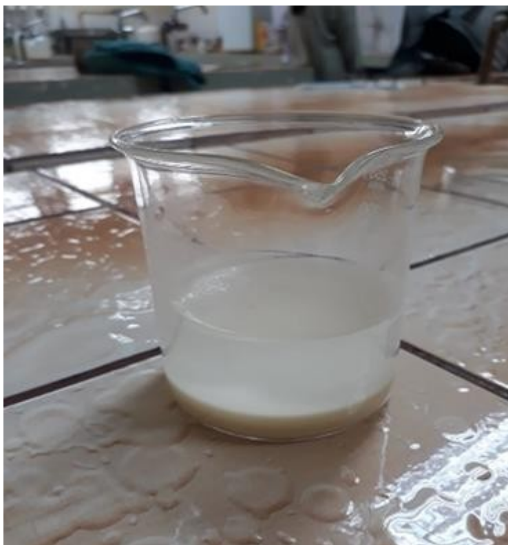
FIGURA 2 Sedimentación del almidón de maíz
