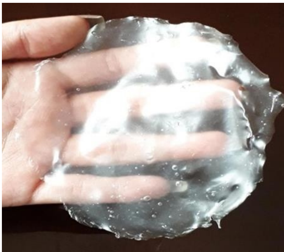
FIGURA 4. Bioplástico de almidón de maíz formado
