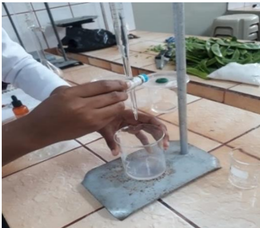
FIGURA 6. Titulación del \text{Ba}(\text{OH})_2 con el \text{HCl} remanente
