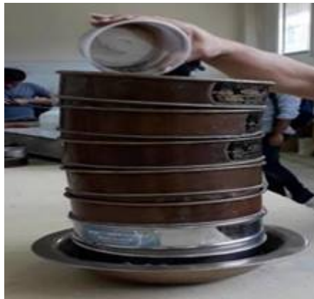
FIGURA 7. Tamizado de la tierra con el bioplástico
