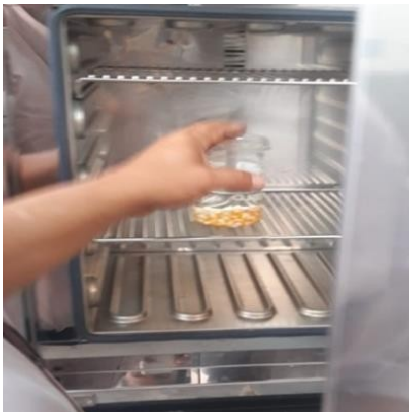
FIGURA 1. Hidratación del maíz para la extracción del almidón
