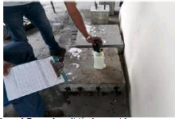
FIGURA 6 Ensayo de medición de potencial elaboración propia
