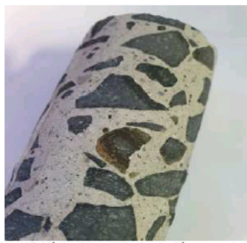
FIGURA 7 Núcleo de tres pulgadas de diámetro usado para análisis visual del perfil del concreto. elaboración propia
