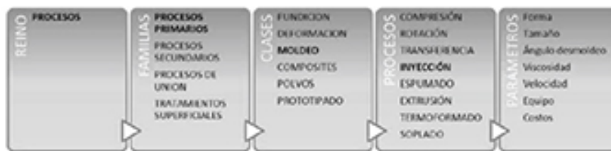
FIGURA 6 Taxonomía de clasificación de procesos de fabricación traducción del original Ashby, Shercliff, & Cebon, 2014
