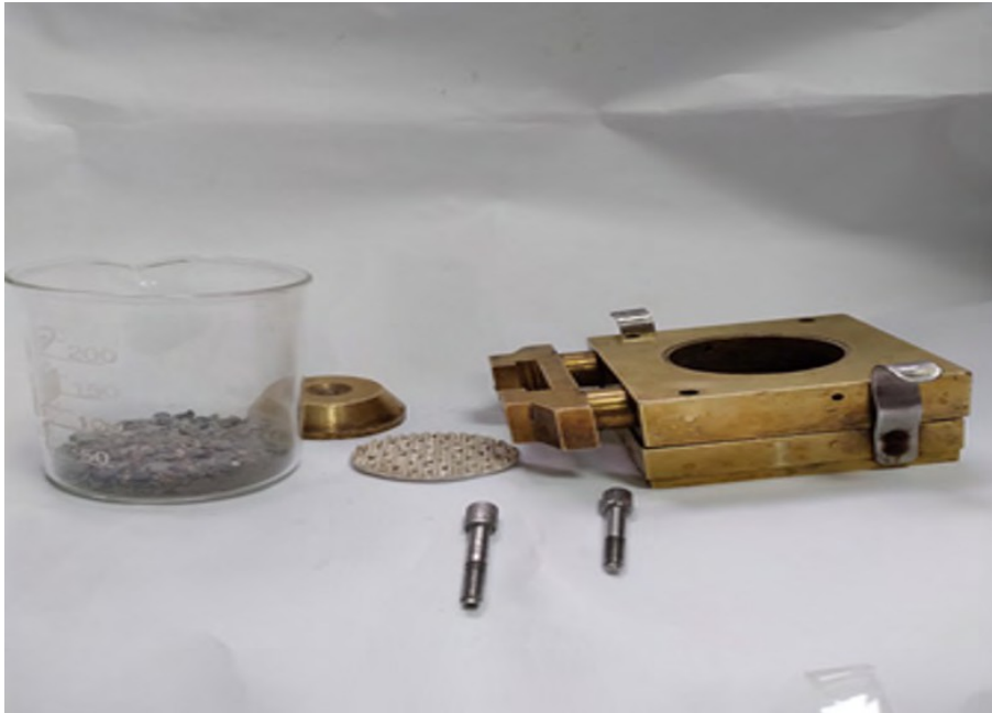
Figura 2 Preparación masa de la muestra (Arena de Ottawa) Elaboración propia
