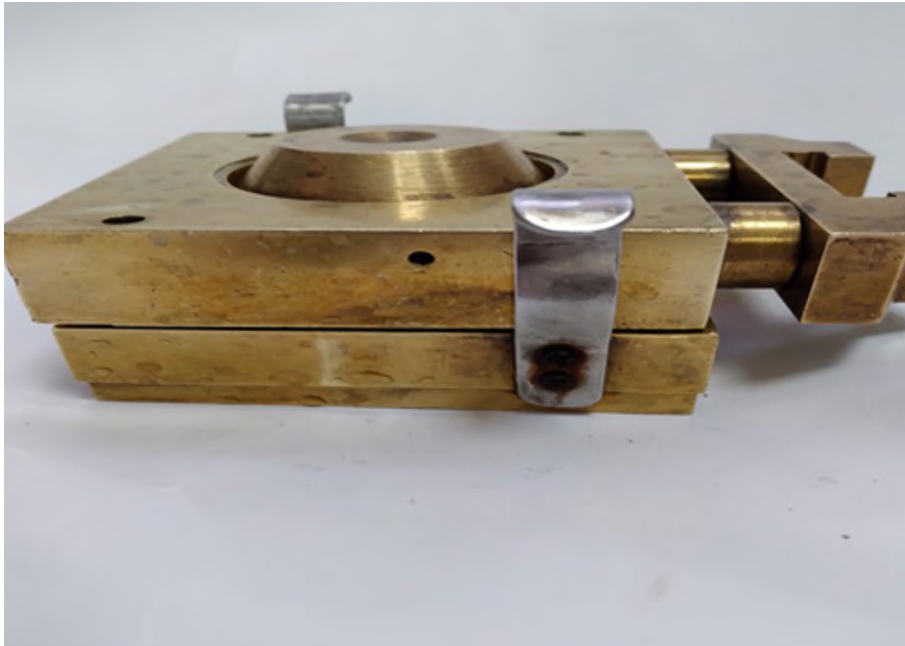
Figura 6. Cámara de corte lista para ser ensayada (Arena de Ottawa) Elaboración propia.
