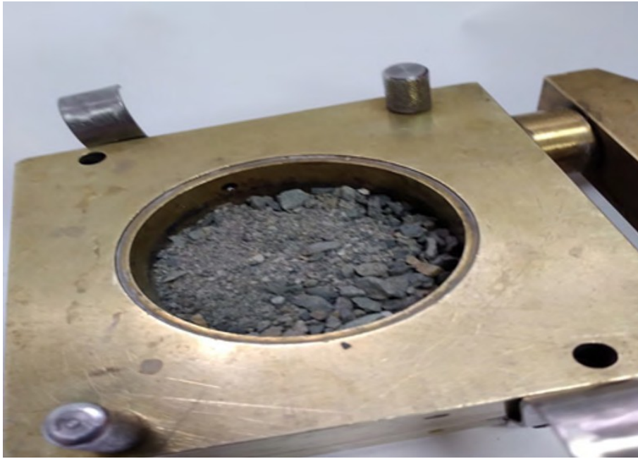
Figura 4 Estado del material dentro de la cámara de corte (Arena de Ottawa) Elaboración propia.
