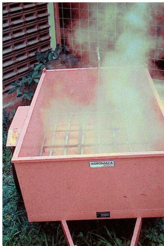
**Figura 13.** Carrucha conectada a una caldera con tubos perforados por donde sale el vapor para desinfección del sustrato.
