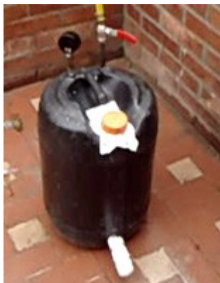
Figura 1. Biodigestor a escala menor, capacidad 50 litros
