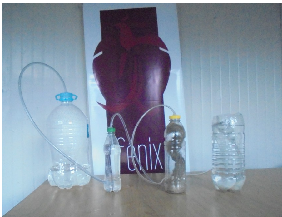
Figura 3. Medidor de gas fotografía tomada por el autor.
