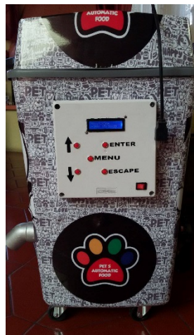
FIGURA 21 Vista principal del dispensador automático de comida para mascota
