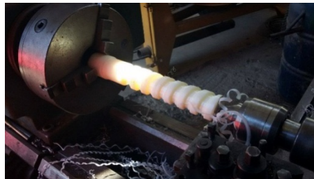
FIGURA 3 Construcción del tornillo sin fin en el torno paralelo
