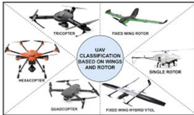
FIGURA 4 Clasificación según las alas y el rotor
