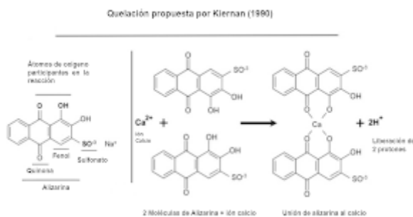
FIGURA 3. Reacción de quelación propuesta por Kiernan (1990). omado y modificado de Piovesana, et al. (2014)
