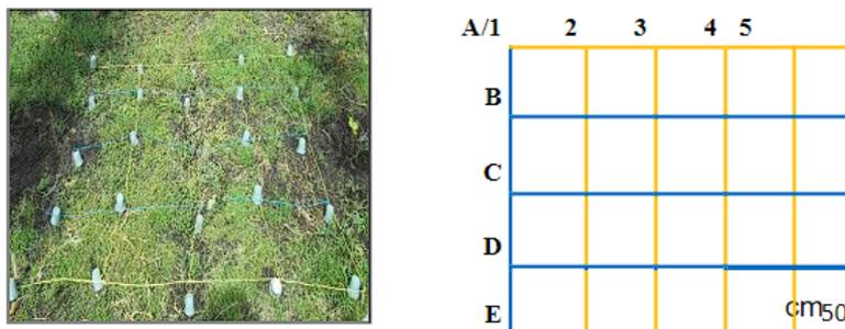
FIGURA 1 Disposición en cuadrícula de los recipientes pluviométricos
