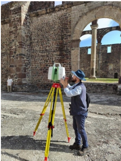
FIGURA 7 Escáner láser terrestre modelo Leica ScanStation C10.
