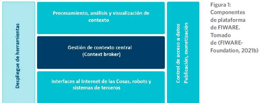
Figura 1: Componentes de plataforma de FIWARE. Tomado de (FIWARE-Foundation, 2021b)
