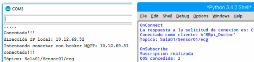
Figura 3. Resultado de la comunicación entre nodo sensor y nodo coordinador.
