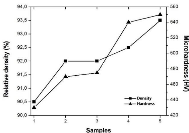
**Figura 2.** Densidad relativa y microdureza de las HEA sinterizadas durante 1h a 1,300°C como una función del contenido de aluminio (x). Al<sub>x</sub>CrCuFeNiTi (x = 0, 0.45, 1.0, 2.5, 5.0 % molar, respectivamente).
