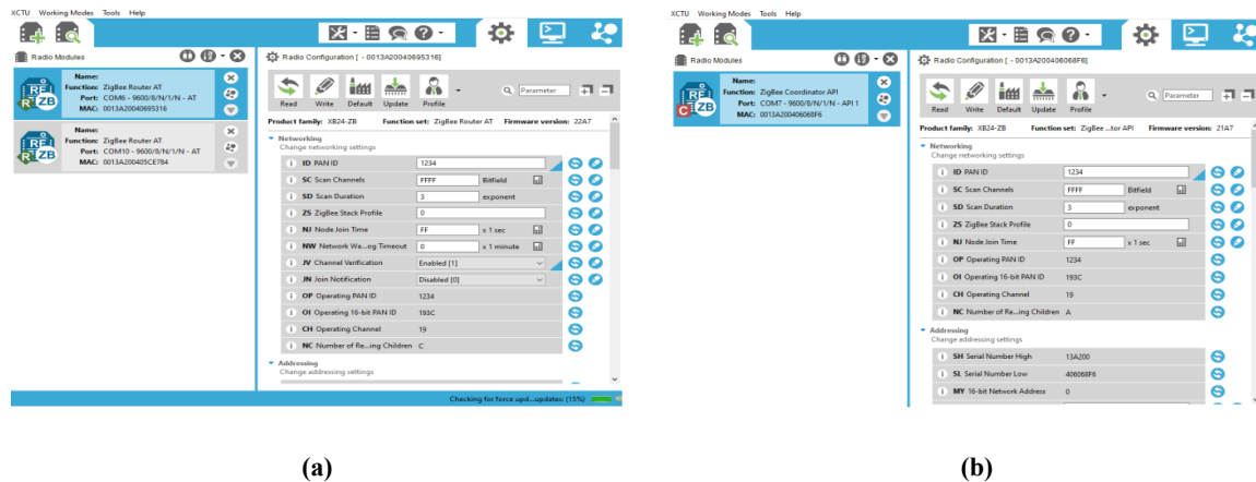
Figura 2. (a) Configuración de los módulos XBee en modo router en el programa XCTU. (b) Configuración del módulo XBee en modo coordinador en el programa XCTU.
