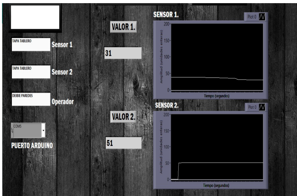
Figura 6. Visualizador en tiempo real de la prueba de control de calidad a partir de datos de vibración.
