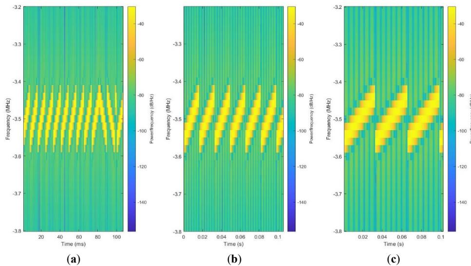
**Figura 2.** Comparación de transmisiones LoRa a diferentes velocidades en un mismo intervalo de tiempo: (a) Factor de *Spreading* de 10; (b) Factor de *Spreading* de 11; (c) Factor de *Spreading* de 12.
