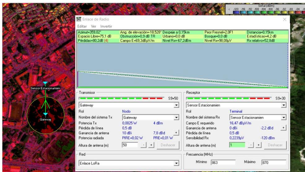
Figura 8. Simulación en Radio Mobile haciendo uso de un escenario obtenido de la EPN.
