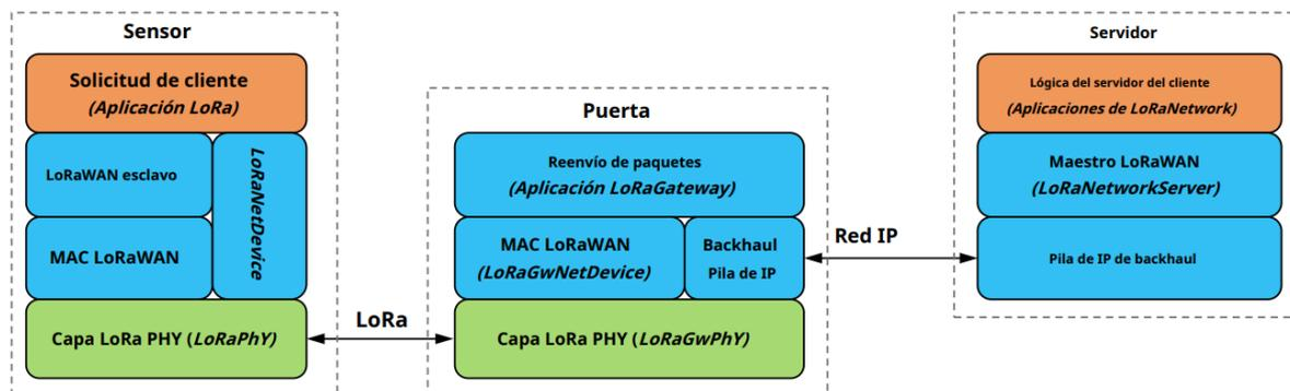
Figura 1. Modelo de funcionamiento de una red LoRaWAN. Fuente: Basado en [2].
