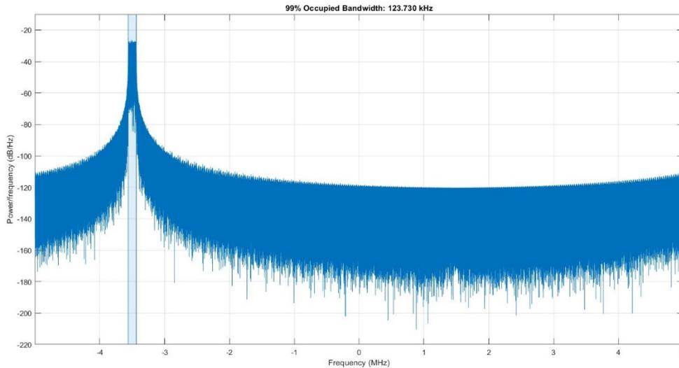
Figura 4. Uso de ancho de banda para transmisión con SF=10.
