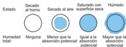
FIGURA 1. Condiciones de humedad de los agregados. Kosmatka et al. [6].
