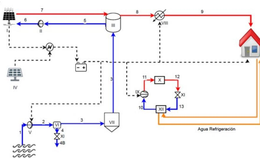
FIGURA 5. Esquema del sistema de poligeneración eléctrico (SPE) para verano.
