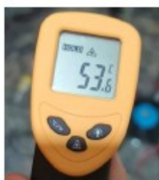
FIGURA 10. Medición de temperatura en el disipador del MOSFET después de 10 minutos.
