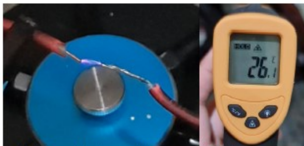
FIGURA 11. Formación de arco eléctrico y medición de temperatura en el disipador del MOSFET después de 10 minutos, circuito 2.
