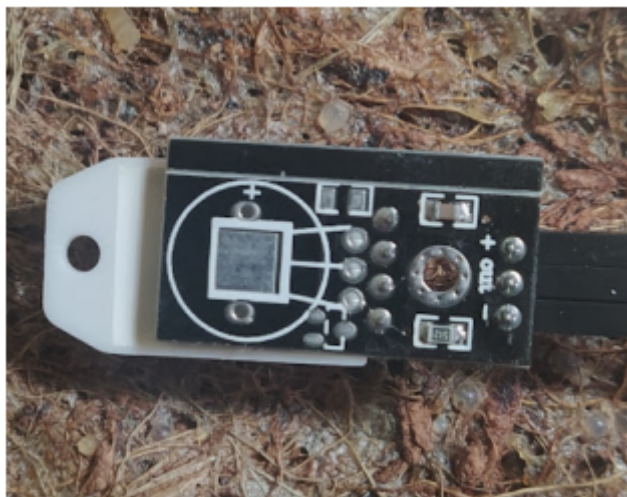
FIGURA 5. Colocación del sensor DHT22 para medir la humedad relativa y la temperatura de las láminas en las tres experiencias.
