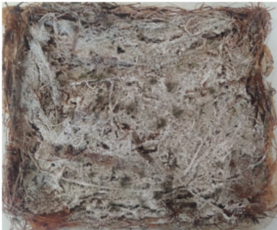
FIGURA 11. Lámina de estopa de coco, pegamento de arroz y sal gruesa, transcurrido 11 meses de su fabricación.
