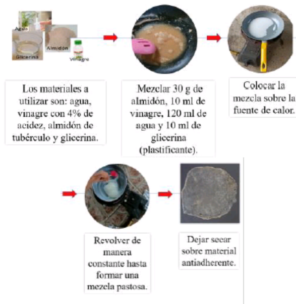
FIGURA 2. Compilación de pasos para la fabricación del biopolímero.
