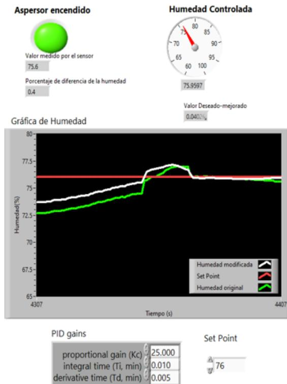
Figura 6. Diseño de interfaz de control de riego en LabVIEW.
