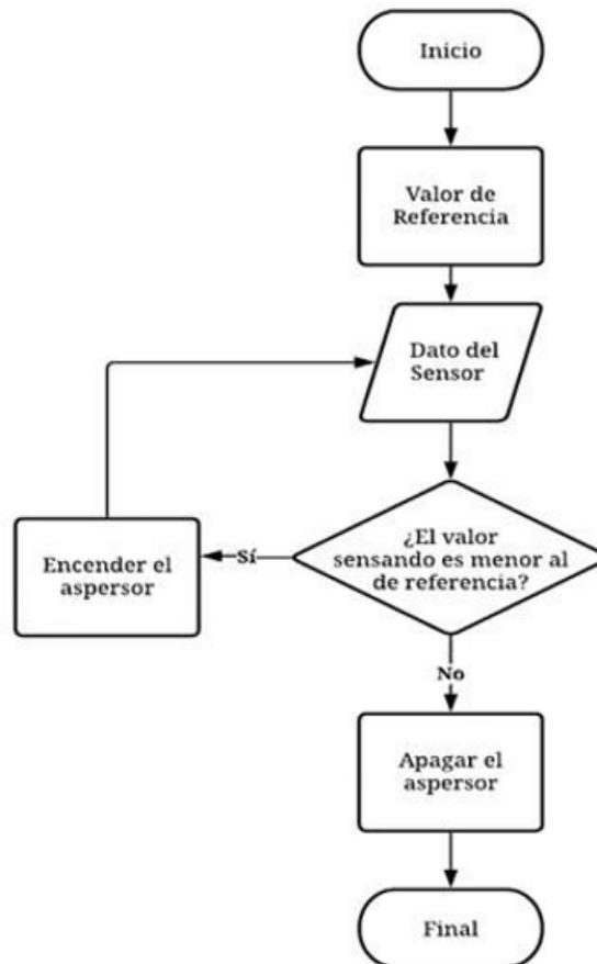
Figura 2. Diagrama de flujo del funcionamiento del sistema de control de humedad.
