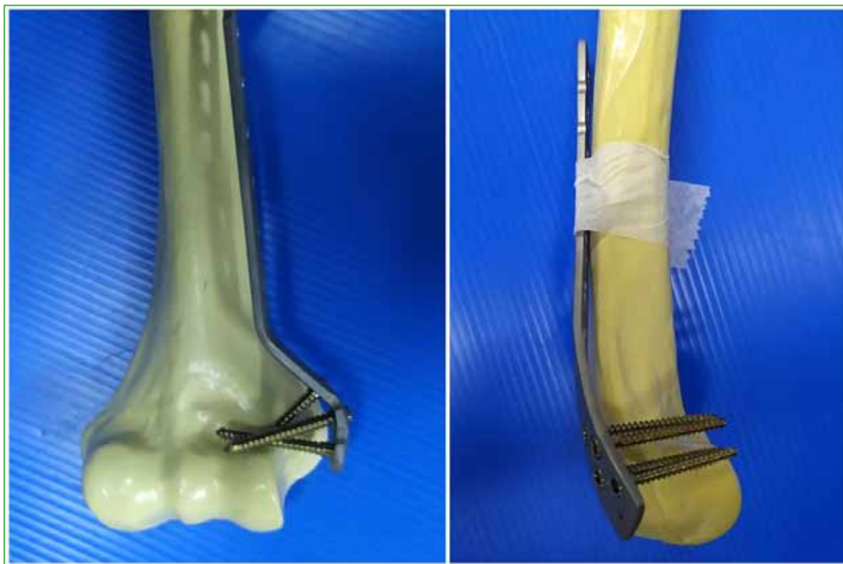
Figura 2. Demostración en hueso plástico de la mala reproducción anatómica y la insuficiente fijación articular de un implante X.
