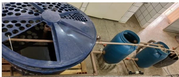
FIGURA 2 Complexo aquícola em sistema de recirculação (RAS)
