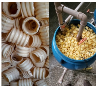
FIGURA 5 Reator aerado de leito móvel com material de suporte microbiano alternativo
