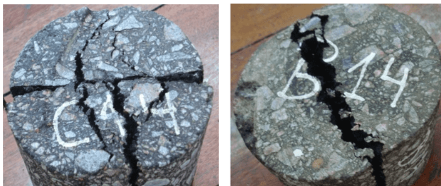
FIGURA 14 Tracción Indirecta a 40 °C. Probeta con refuerzo (izq.) y sin refuerzo (der.)
