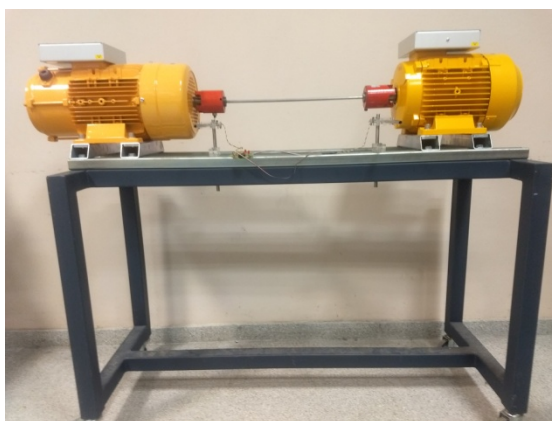
Fig. 1 - Vista del generador, eje de torsión, motor y los sensores en cada manchón
