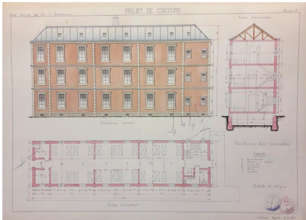
Figura 9. Criterios de dimensionamiento y modulación de los pabellones tipo, explicados con croquis a mano en tinta, cotas y textos, en la memoria descriptiva del proyecto final de la ECP. Fuente: Agote (1890). | Figura 10. Pabellón de incurables. En relación con los cálculos realizados en la memoria descriptiva se dibujan los épures en láminas de gran formato del proyecto final de la ECP. Fuente: Agote (1890).
