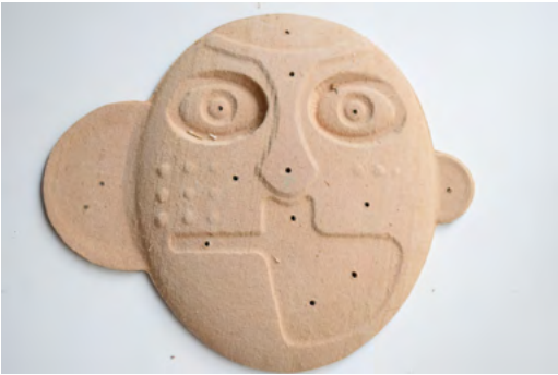
Figura 2. Matriz realizada por control numérico. Fuente: elaboración propia (2021). | Figura 3. Molde realizado por termoformado. Fuente: elaboración propia (2021). | Figura 4. Piezas de micelio realizadas a partir del mismo molde. Fuente: elaboración propia (2021)
