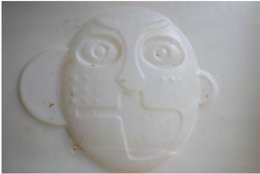
Figura 2. Matriz realizada por control numérico. Fuente: elaboración propia (2021). | Figura 3. Molde realizado por termoformado. Fuente: elaboración propia (2021). | Figura 4. Piezas de micelio realizadas a partir del mismo molde. Fuente: elaboración propia (2021)
