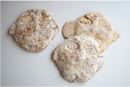
Figura 2. Matriz realizada por control numérico. Fuente: elaboración propia (2021). | Figura 3. Molde realizado por termoformado. Fuente: elaboración propia (2021). | Figura 4. Piezas de micelio realizadas a partir del mismo molde. Fuente: elaboración propia (2021)
