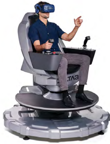
Figura 4. Simulador multipropósito S1, empresa Delta 3, el simulador sirve para capacitar operarios en maquinaria pesada, evitando riesgos simulando situaciones críticas gracias a la realidad aumentada. Recuperado de http://www.deltatres.com/
