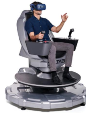
Figura 4. Simulador multipropósito S1, empresa Delta 3, el simulador sirve para capacitar operarios en maquinaria pesada, evitando riesgos simulando situaciones críticas gracias a la realidad aumentada. Recuperado de <http://www.deltatres.com/>
