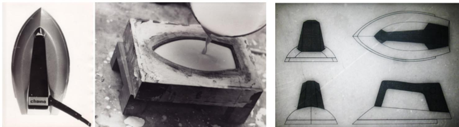
Figura 8. Construcción de la plancha Chaina: desde el dibujo al colado de piezas en moldes. (Archivo Fundación IDA).
