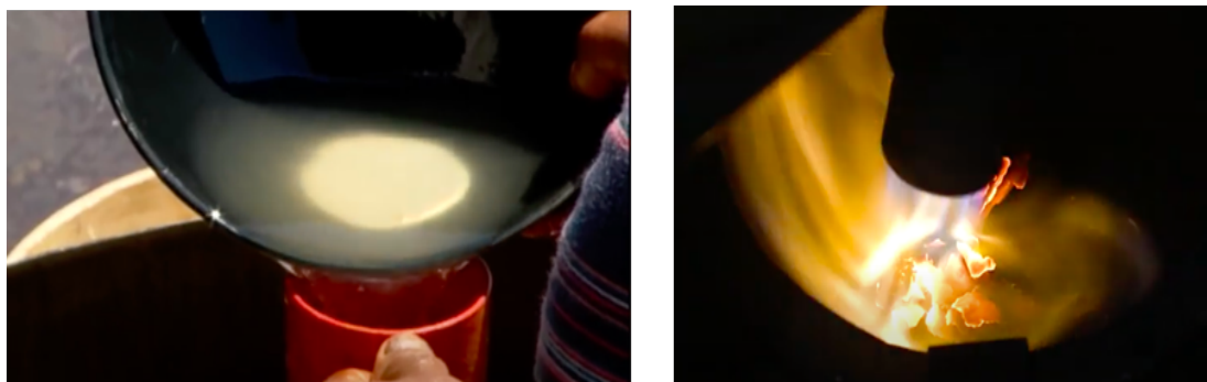
Figuras 6 e 7 - Processo de aderência ao mercúrio à esquerda e a volatilização do mercúrio à direita.
