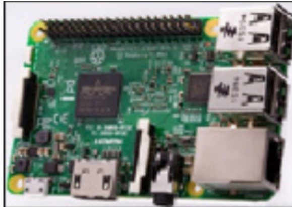
Figura 2 Raspberry pi 3 modelo B Fuente 5 [5]
