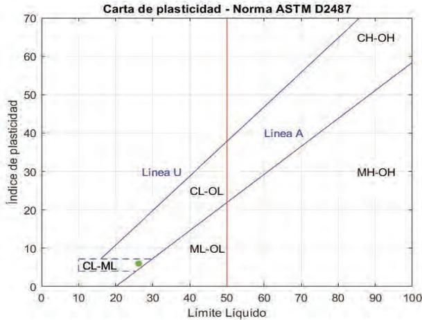
Figura 1. Carta de plasticidad – Norma ASTM D2487
