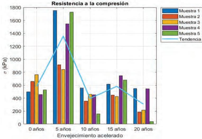
**Figura 2. Resistencia a la compresión. Resultados obtenidos**
