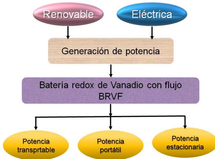
**Figura 6. Aplicaciones de Batería Redox de Vanadio con Flujo** (Márquez, et al. 2021)
