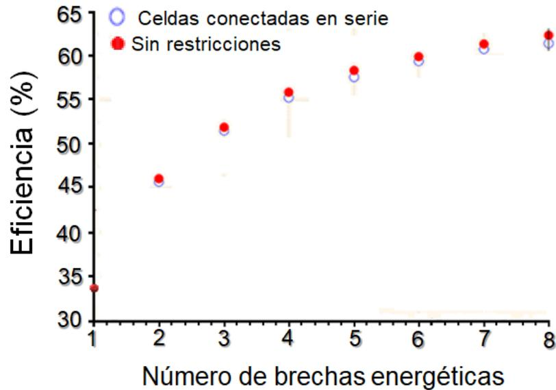
**Figura 4. Eficiencia de una pila de celdas solares como función del número de bandas prohibidas. El espectro utilizado aquí es el espectro directo (AM 1.5 G), donde se excluye la radiación difusa (Bremner, Levy, & Honsberg, 2008)**
