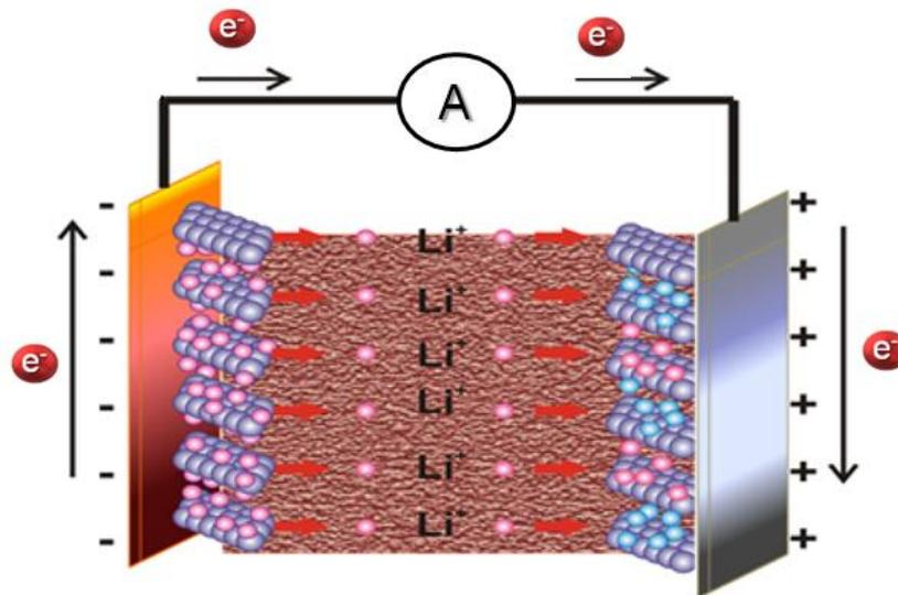
**Figura 5. Descripción de un modelo de celda de ion-Litio. (-) Material carbonado. (+) LiCoO<sub>2</sub>**
