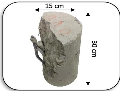
**Figura 1. Muestra de cilindro de hormigón armado**
