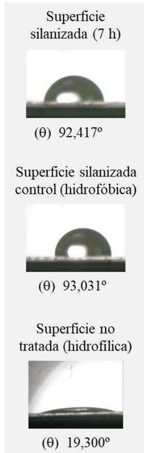
**Figura 3. Fotografías y valores de ángulos de contacto de referencia de una gota de agua bidestilada depositada en superficie obtenida en este trabajo: superficie silanizada 7h, control y superficie hidrofílica. El ángulo de contacto ( $\theta$ ) se muestra en grados  $^\circ$ .**
