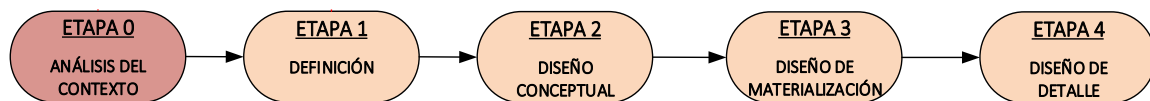
Figura 1. Secuencia básica de etapas de la metodología propuesta para el diseño en ingeniería concurrente
