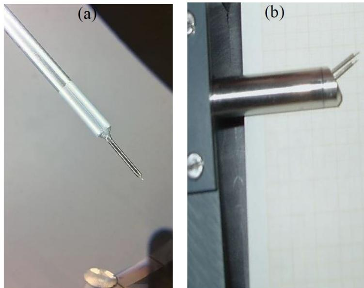
Figura 2. Sondas: a) Conductividad; b) fibra óptica.
