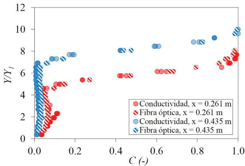
Figura 3. Comparación de la distribución de fracciones de vacío.  $F_r = 7.6$ ,  $Re = 7.65 \cdot 10^4$ ,  $V_1 = 2.88$  m/s.
