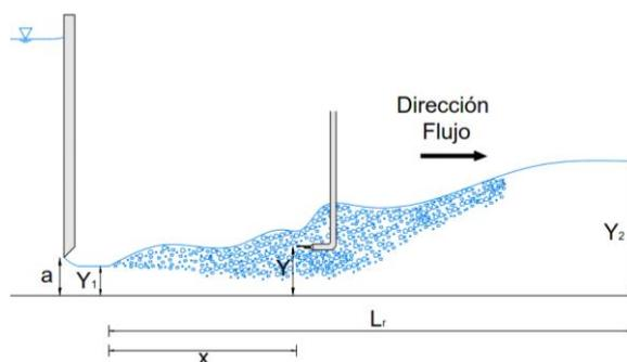
Figura 1. Esquema del resalto hidráulico no desarrollado ensayado.
