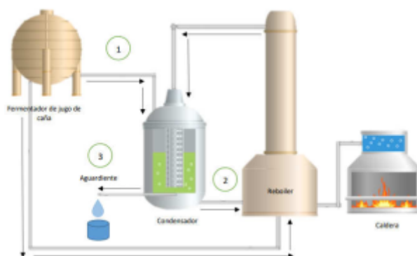
FIGURA 7. Diseño de alternativa para la reducción de costos energéticos en la producción de aguardiente de caña de azúcar.
