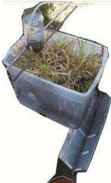
Figura 5. Ensayo en modelo físico: dispositivo simulador de lluvia (parte superior); canaleta y recipiente receptor (parte inferior).
