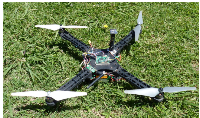
Figura 4. UAV utilizado para la validación experimental del autopiloto.
